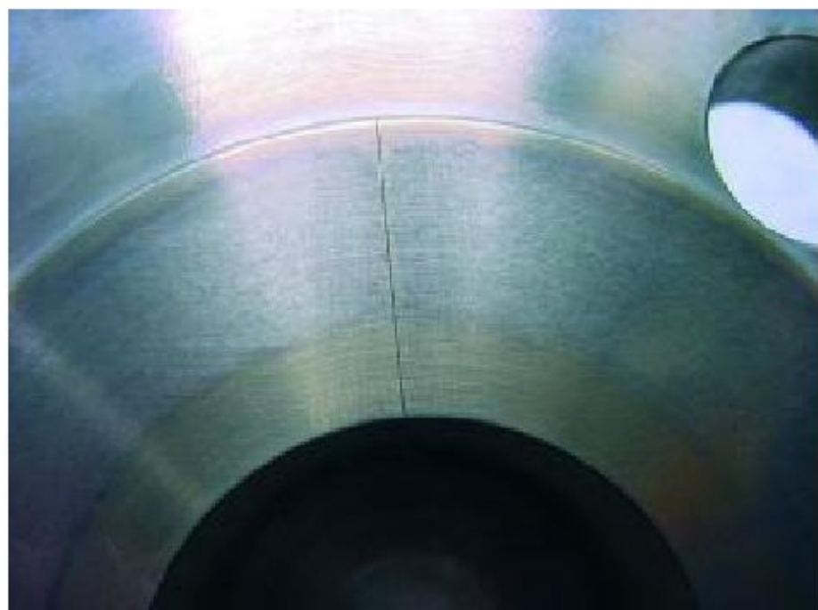
Obrázek 4: Rýha s hloubkou 95 \mu\text{m} a šířkou 150 \mu\text{m}
